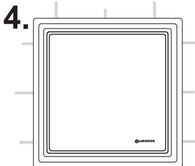
4. Abdeckplatte am Lüftungsggerät aufsetzen und aufdrücken bis alle Rasthaken einrasten.
