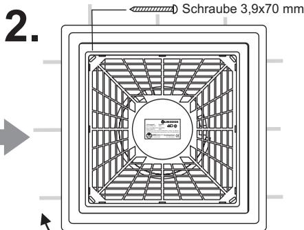
2. Gehäusedeckel mit Vorsatzrahmen LV-4 waagrecht ausrichten und festschrauben.
