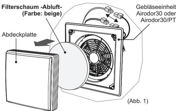
Abdeckplatte abziehen und Filterschaum auf/in der Gebläseeinheit für Reinigungszwecke entfernen.
